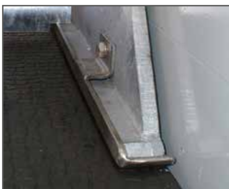
Breite und hochgezogene Seitenkufen angeschraubt
