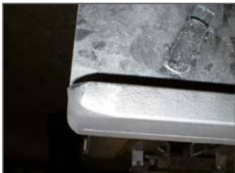
Auflagefläche der Seitenkufe abgerundet
