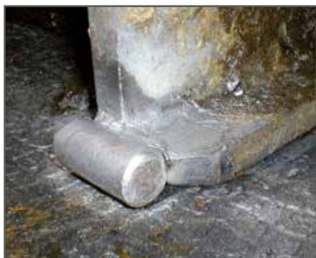
Seitenkufen mit Rundeisen und breiter Auflage
