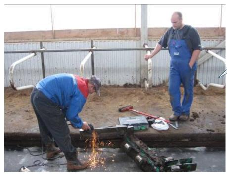
**Tipp:** Schieber umdrehen, scharfe Kanten kontrollieren und gegebenenfalls mit der Flex entgraten
