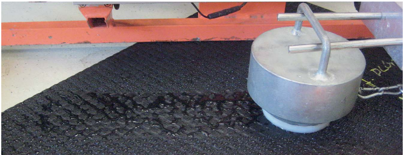
Bild 3: Messung der Rutschfestigkeit in nassem Zustand
