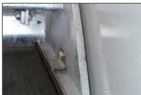
breite und hochgezogene Seitenkufen angeschraubt
