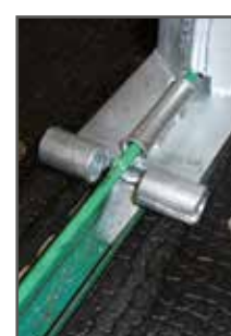
breite Auflage für Mittelbock, Rundeisen angeschweißt
