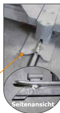
breite Auflage für Mittelbock, Rundeisen angeschweißt
