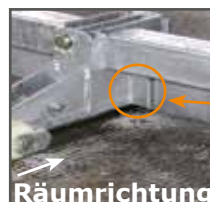
Räumklappenanschlag: kein Bodenkontakt
