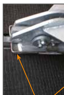
breite Auflage für Mittelbock, kufenförmig hochgezogen
