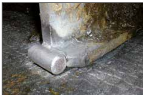
Seitenkufen mit Rundeisen und breiter Auflage
